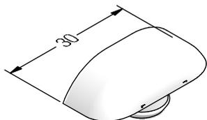
Колпачок водоотвода (круглое отверстие)
