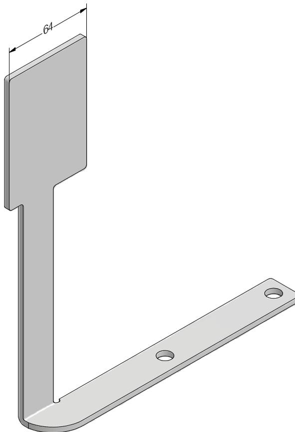
Монтажный уголок 2 для профиля компенсирующего 2
