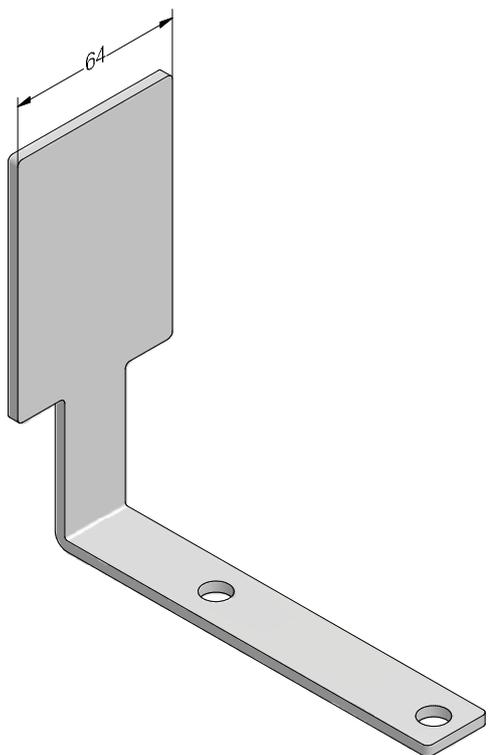
Монтажный уголок 1 для профиля компенсирующего 2
