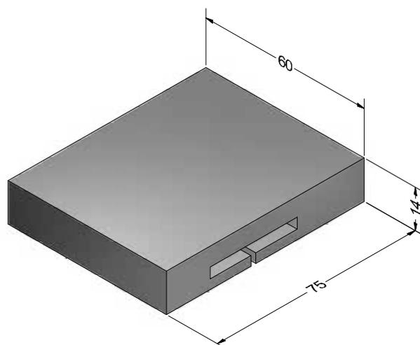
Уплотняющая вставка профиля компенсирующего 2
